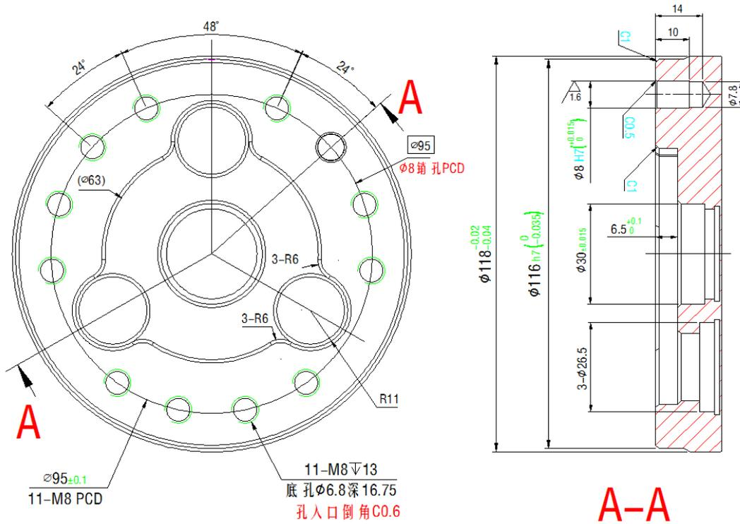
图 6-5: 连接法兰
